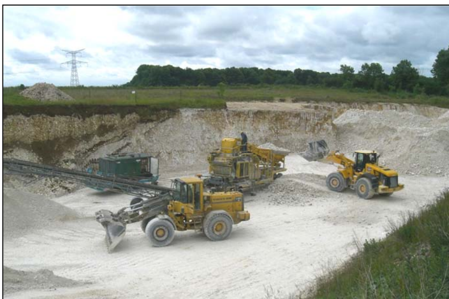
Vue sur une installation de broyage-criblage (carrière CABC de Fresnes-Mazancourt)
